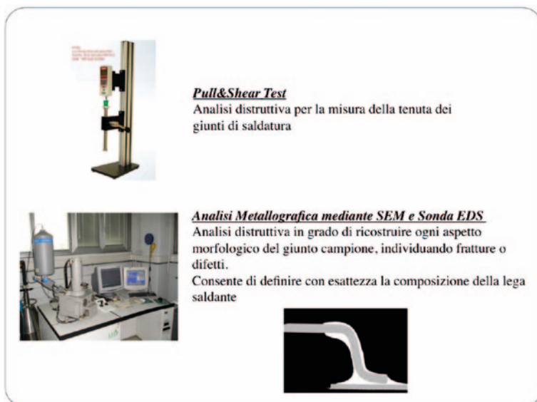
Fig. 4 - Push & Shear Test e analisi metallografica
